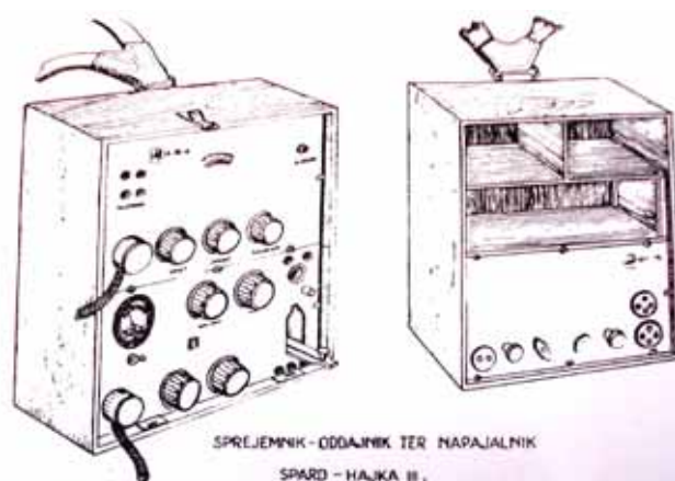
Sprejemno-oddajna postaja H-III (Hajka-III); zunanje mere: 340×430×200 mm, izhodna moč: 18 W, valovna dolžina: 70 m—95 m; 95 m—110 m; napajanje: akumulator prek motorgeneratorja; število izdelanih postaj: 6; čas izdelave: marec — april 1944.
